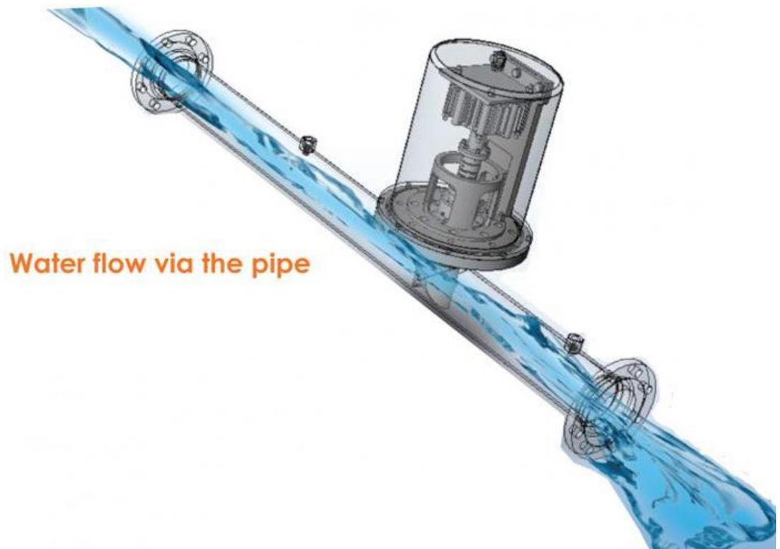
**Figura 5. Esquema de funcionamiento de una microturbina hidráulica planteada para recuperar parte de la energía consumida en el bombeo de una planta acuícola.**
