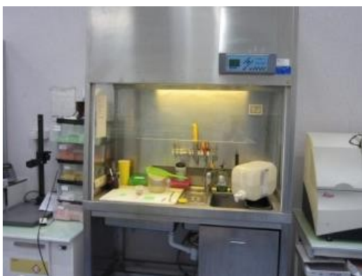
Figura 15. Campana de tallado con filtro de carbono
