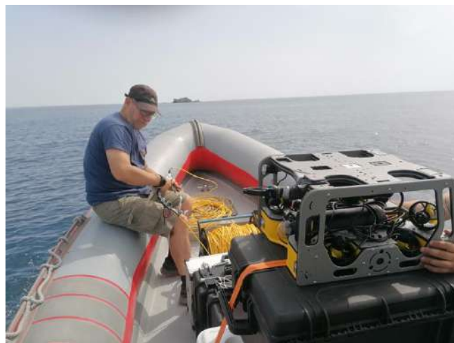
Figura 5. Fotografía del ROV en detalle donde también se aprecia el cable de conexión del ROV con el ordenador.
