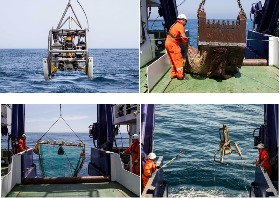
Foto 7. Tipos de muestreadores utilizados en las campañas donde se comparan los estados de los hábitats bentónicos en función de un gradiente de presión. De arriba abajo y de izquierda a derecha: trineo fotogramétrico, draga de roca, bou de vara y draga Box Corer.
