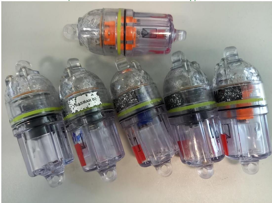
Figura 4. Sensores de movimiento alojado en carcasas submarinas.
