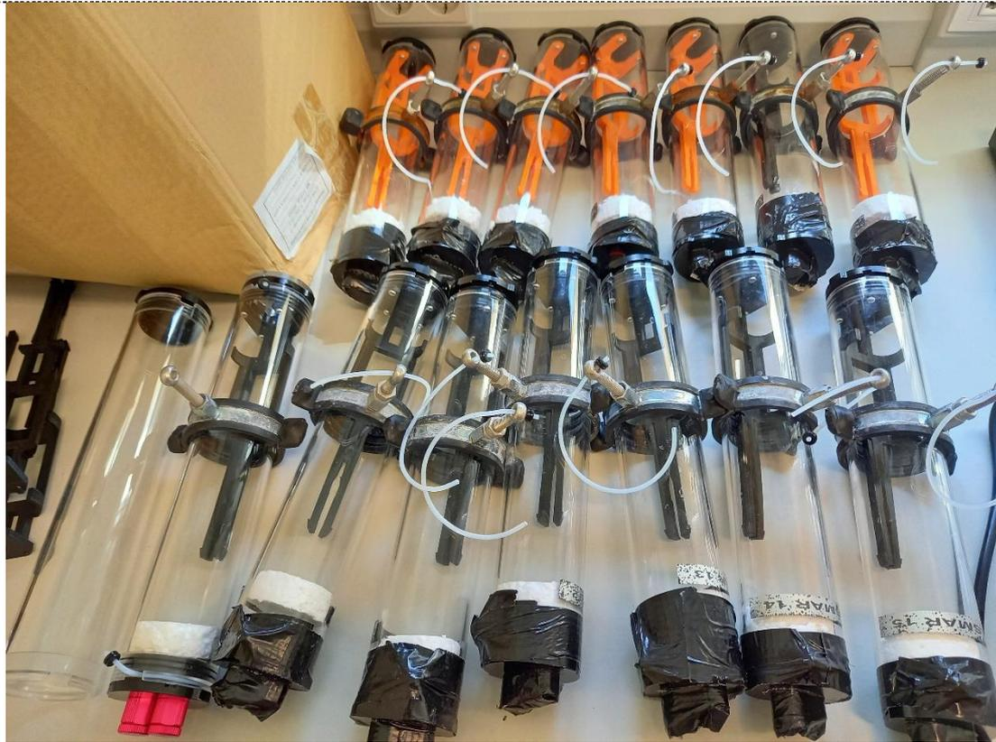
Figura 2. Carcasas de metacrilato con estructura de fijación del sistema de grabación.
