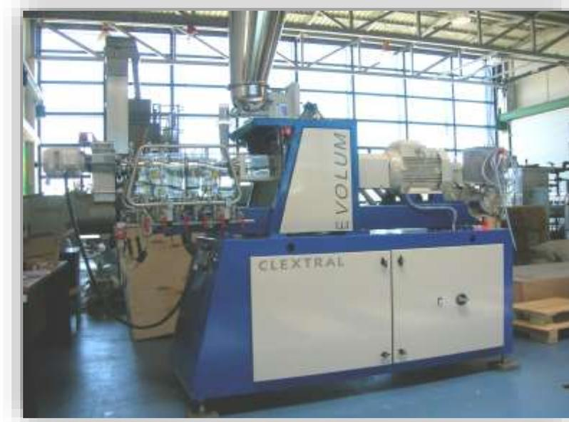
**Figura 4.** Extrusor de la planta de extrusión de CARTIF.
