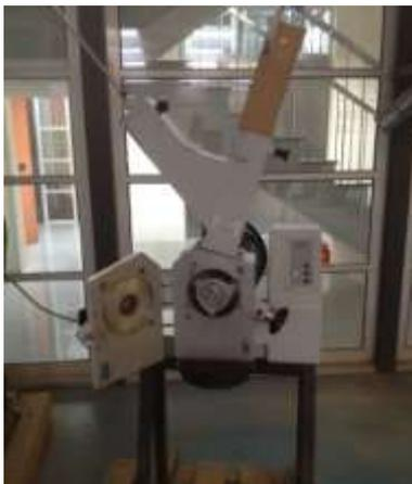
**Figura 3.** Molino de cuchillas Retsch empleado para moler los ingredientes.
