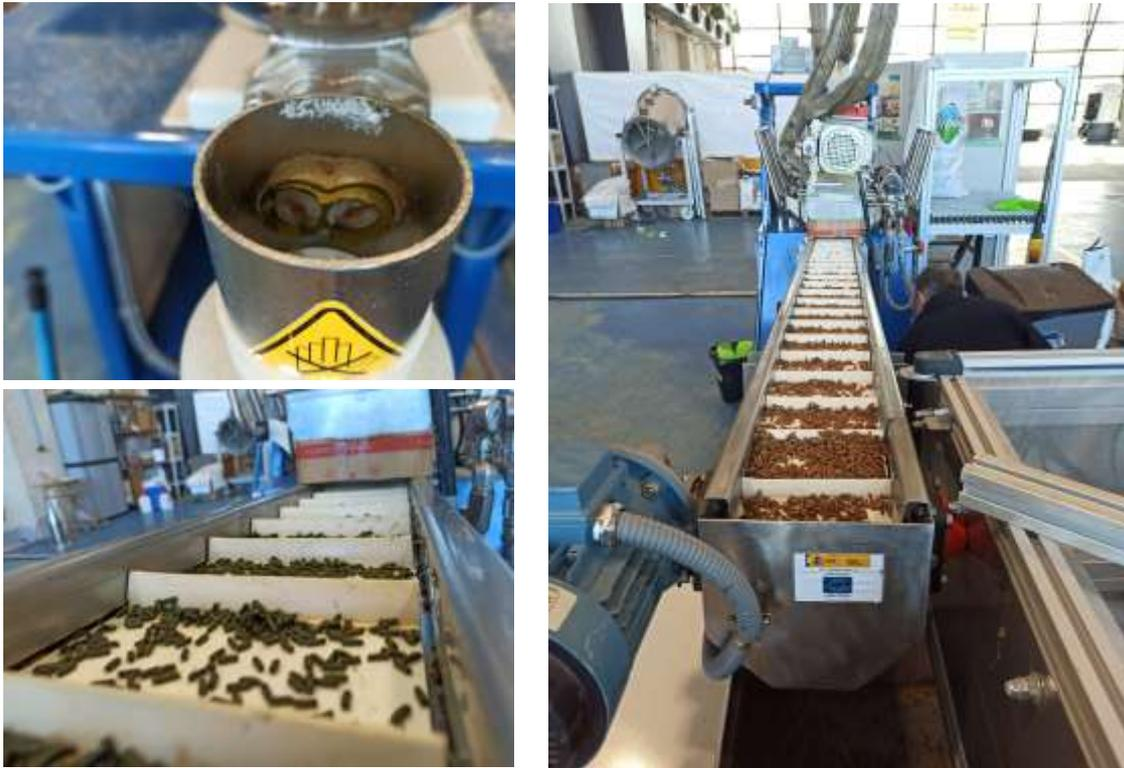
**Figura 5.** Proceso de extrusión de los piensos.
