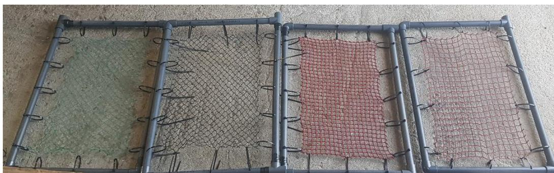
**Figura IV:** Redes tratadas con antifouling en bastidores individuales. De izquierda a derecha: red control, nuevo tratamiento desarrollado, Netwax NI3 y AquaNet Premium.
