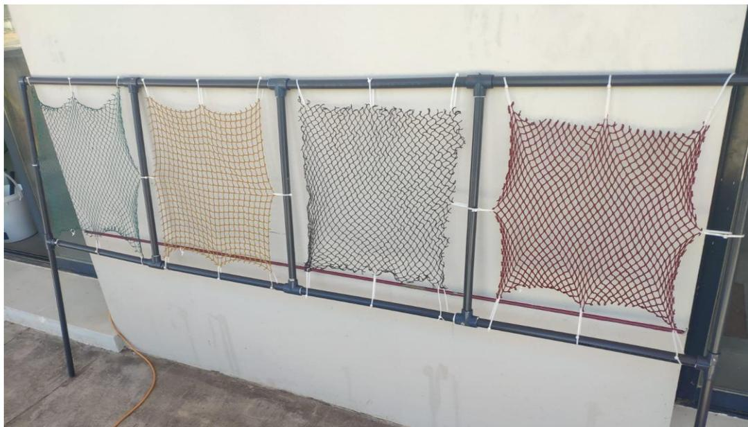
**Figura II:** Bastidor de PVC con las redes tratadas. De izquierda a derecha: red control, AquaNet Protect, nuevo tratamiento desarrollado y Netwax NI3.
