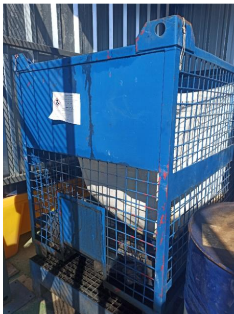
Figura 228: Estructura para big bag para envases de residuos peligrosos en el puerto de Valencia.
