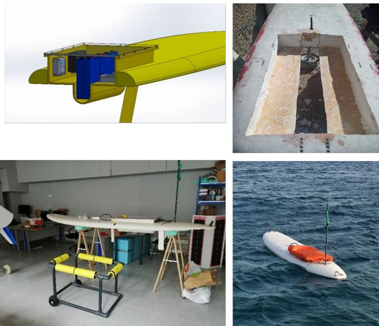
**Figura 15.** Distintas fases de la construcción de la plataforma y aspecto final (sin paneles fotovoltaicos instalados).
