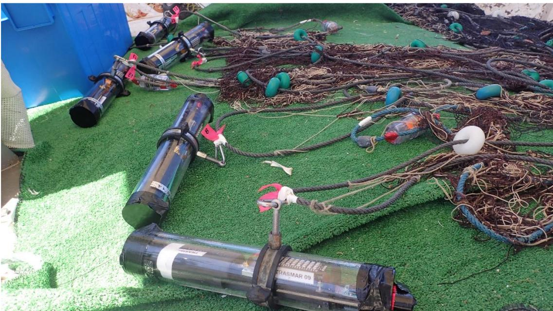
Foto 1.- Imagen de las redes de trasmallo equipadas con cámaras y sensores.
