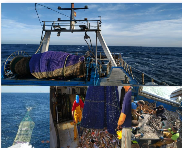
Figura 2. Maniobra de arrastre. Recogida de la red, volcado de captura y separación de capturas comerciales y del descarte (triaje).
